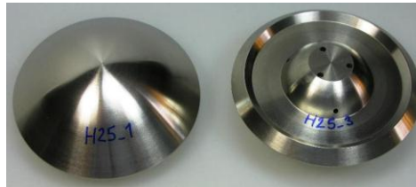
Model H_25 (tungsten: m=1150 g) X_{cg}/D = 25\%
